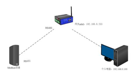
说明: 网关通过 RS485 接口与 Modbus 设备的 RS485 接口相连,实现网关串口采集设备。
