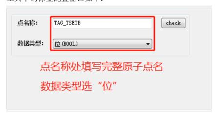
b. 数组 BOOL 量写入。假设底层设备有 N 个指示状态的源变量需要写入 PLC,由于原子点写入效率低,我们可以在 PLC 中创建一个尺寸为 32 位的 BOOL 量数组点(注意,BOOL 量数组点只支持 32 位,其他尺寸大小的 BOOL 数值暂不支持),点名"TAG TESTA",配置如下:
